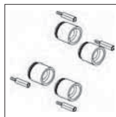
Verlängerungsatz für zu tiefen Einbau: A960704NU 20 mm A962476NU 40 mm
