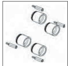
Verlängerungssatz für zu tiefen Einbau: A960704NU 20 mm A962476NU 40 mm
