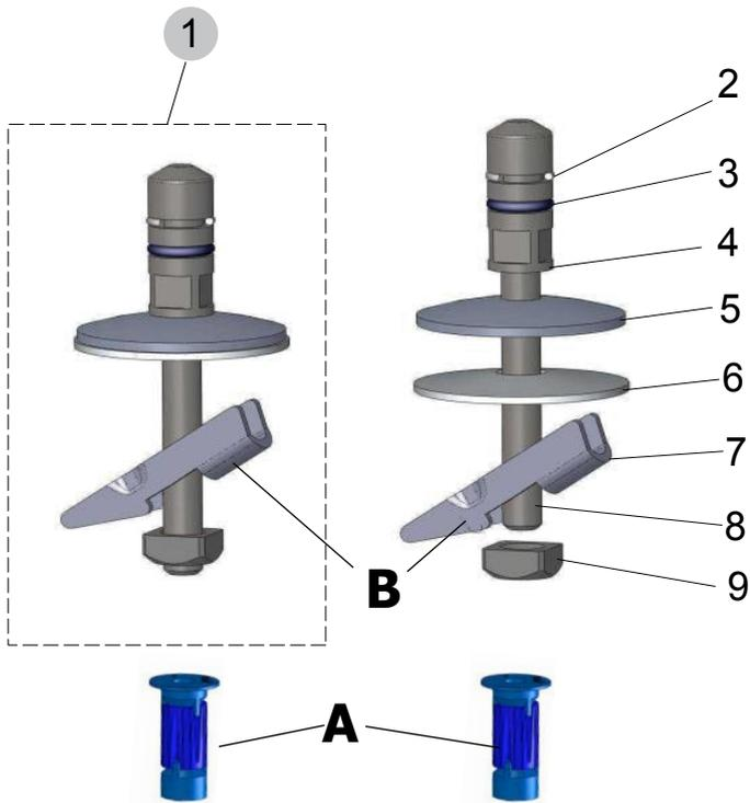
Scharnier-Set mit Befestigung **A** für Keramik mit Sackloch und mit Kippdübel-Befestigung **B** für Durchgangsloch in der Keramik.
