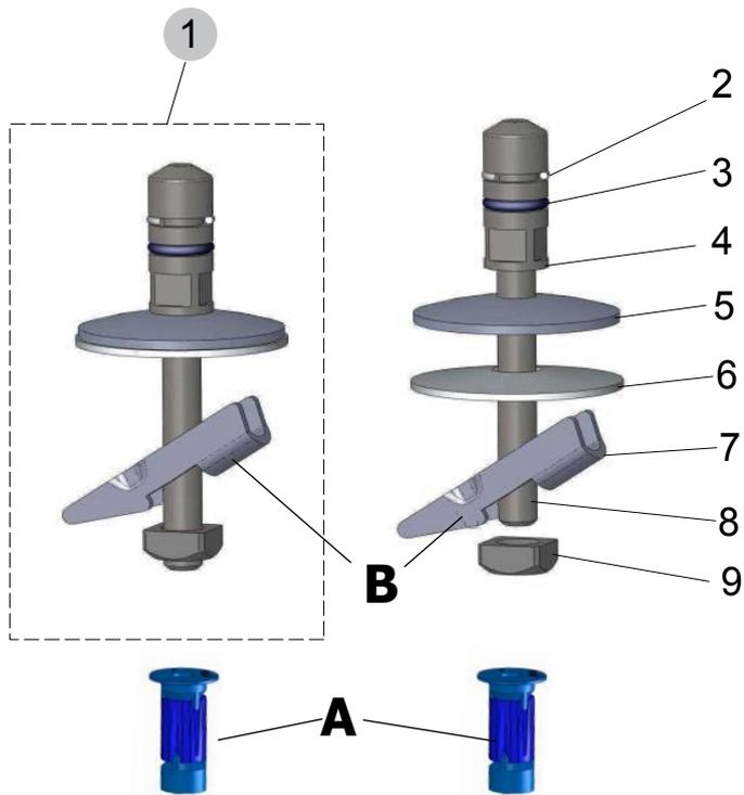
Scharnier-Set mit Befestigung **A** für Keramik mit Sackloch und mit Kippschraube-Befestigung **B** für Durchgangsloch in der Keramik.
