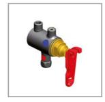
3. Multitool um 90° drehen um die Maximaltemperatur (Heißwasserzulauf) zu erreichen
